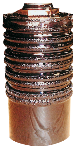
図II. 二次摩耗状態図 (5000~10000km走行時)
